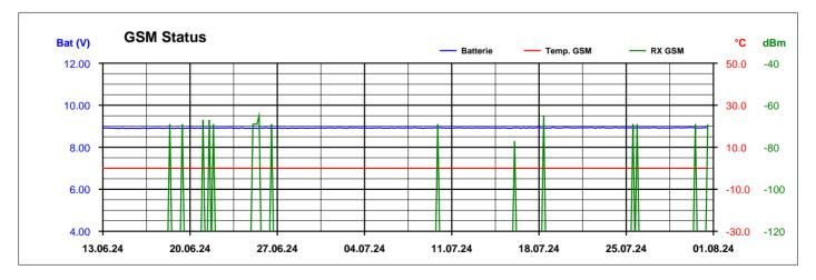
Bei jeder Uebermittlung wird auch die Batteriespannug, die Temperatur im GSM Modul und der Empfangspegel gemeldet. Zur Stronversorgung werden 6 LR20 Zellen verwendet. Sie müssen bei ca. 6V ersetze werden. (ca. alle 2 Jahre)
