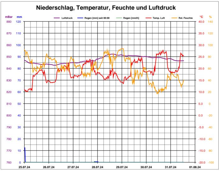
Die Station misst alle 30 Minuten die Lufttemperatur, den Luftdruck, die relative Feuchte und den gefallenen Niederschlag. Die Niederschlagsmenge wird jeweils ab Mitternacht aufsummiert dargestellt. Da die Station nicht beheizt ist, kann Niederschlag nur bei Temperaturen über dem Gefrierpunkt gemessen werden. Schnee der sich im Fangtrichter befindet und schmilzt, erzeugt auch Niederschlag!
